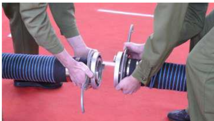
Rys. 8a: Nakładanie kluczy i łączenie węży ssawnych.
